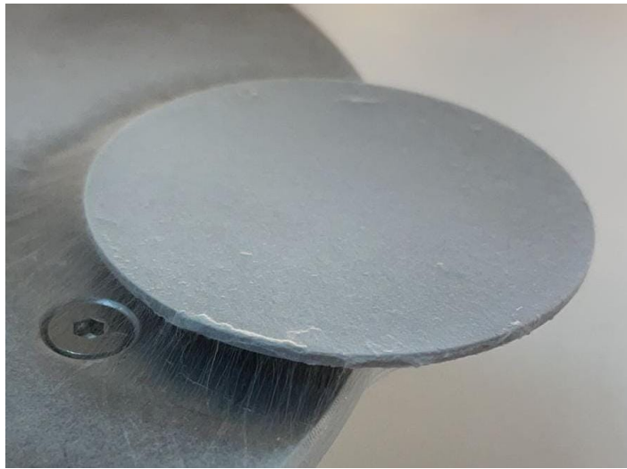
Fig. 3.10 – Disco del reometro con rivestimento elettrofilato
