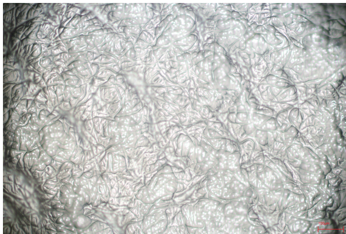
Fig. 6.40 – LIS impregnata con olio di vaselina 100x
