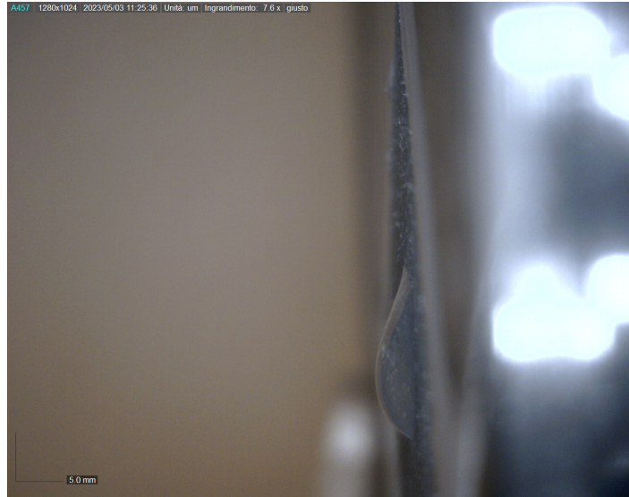
Fig. 7.47 – Angolo di tilt per LIS impregnata con olio di vaselina
