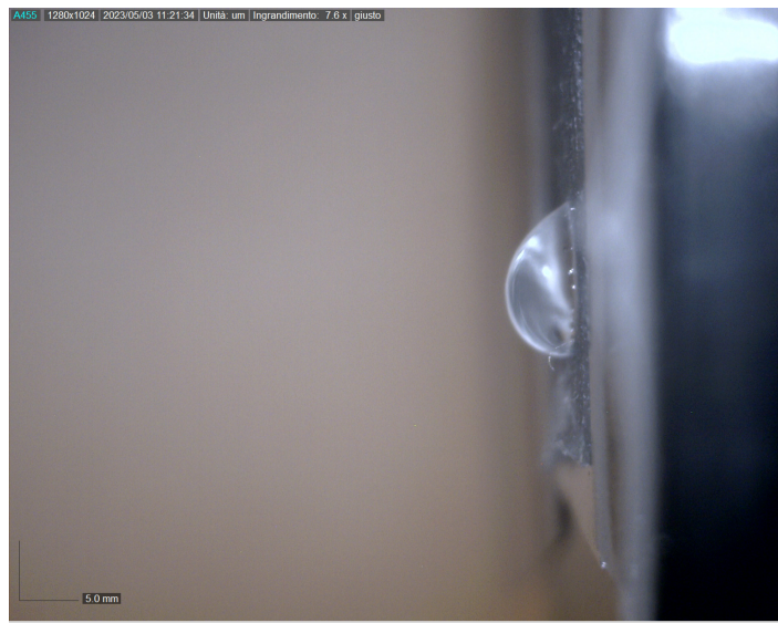
Fig. 7.46 – Angolo di tilt per LIS impregnata con olio di silicone 500cSt
