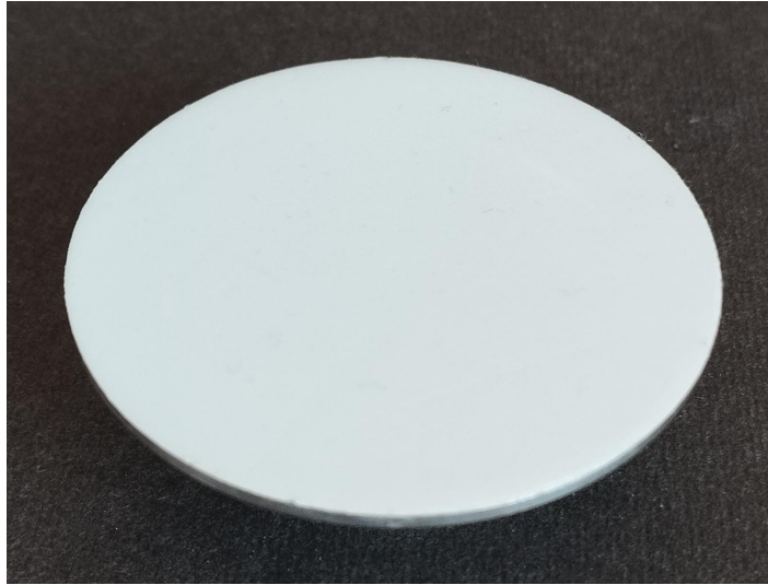
Fig. 5.32 – PCL 3, rivestimento elettrofilato applicato tramite incollaggio
