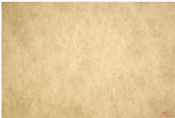
Fig. 3.12 – Disco del reometro con rivestimento elettrofilato 100x
