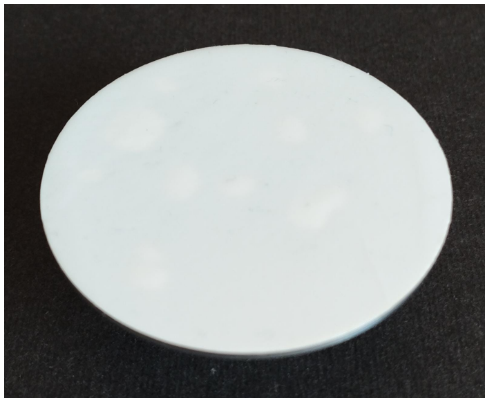
Fig. 5.31 – PCL 2, rivestimento elettrofilato applicato tramite incollaggio
