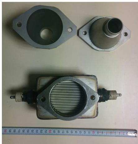
Figure 11: *Prototipo di generatore di ozono.*
