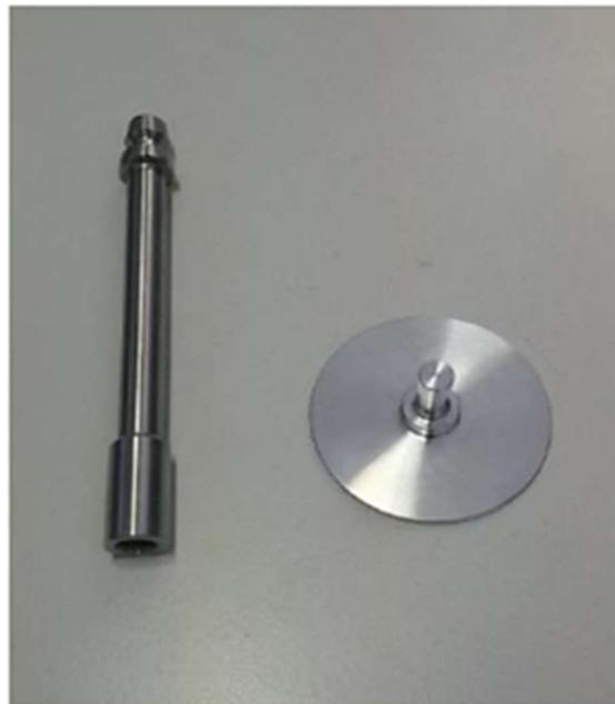
*Figura 19-Asticella utilizzata per l'attacco del disco al reometro*
