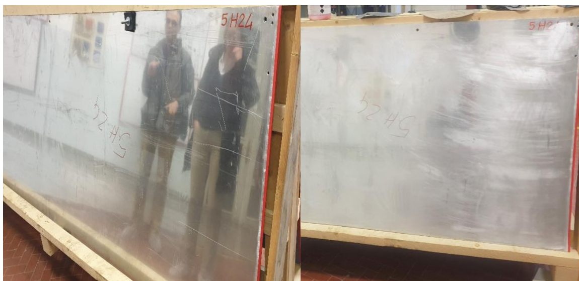
Fig. 3.1 – A sinistra la lastra con le rigature prima della levigazione, a destra la stessa lastra, come mostra il codice 5H24, dopo la levigatura con la cartavetro P400 e la sgrassatura.
