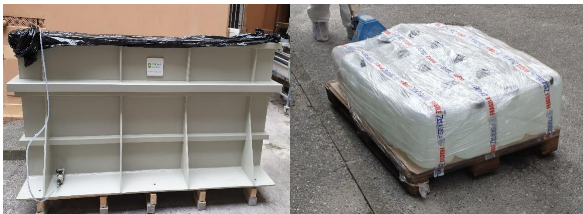
Fig. 3.2 – La figura mostra la vasca che è stata utilizzata e le venti taniche di acido da 10 litri ciascuna posizionate sul bancale
