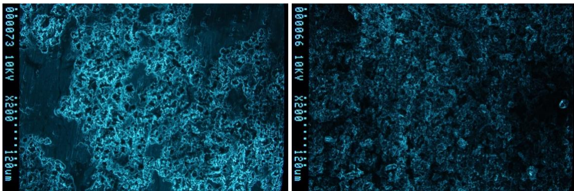
Fig. 3.16 – Immagini al SEM della superficie serie 5000 dopo 30 min a sinistra e 45 min a destra.
