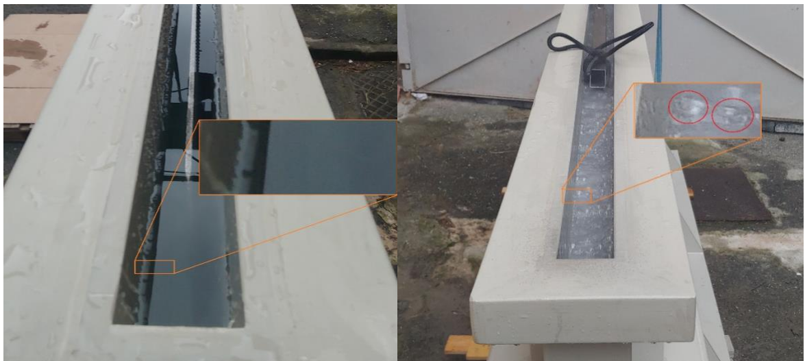
Fig. 3.5 – Immagini relative alle reazioni chimiche che avvengono durante la corrosione. A sinistra la lastra è stata appena calata nella vasca e la reazione che sta avendo luogo è quella tra l'ossido di alluminio e il cloruro di idrogeno, infatti non sono presenti bollicine di idrogeno sulla superficie libera poiché come prodotto oltre al cloruro di alluminio si ottiene acqua. Nell'immagine a destra la reazione che sta avvenendo è quella tra l'alluminio e il cloruro di idrogeno. Osservando la superficie, sembra che la soluzione stia "bollendo", in realtà, questo effetto è dovuto alla risalita dell'idrogeno ( H_2 gas) che si è formato dalla reazione dei due reagenti.
