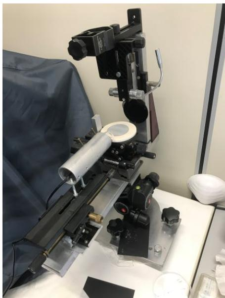
*Figura 7.3: Misuratore d'angolo di contatto e goccia pendente*
