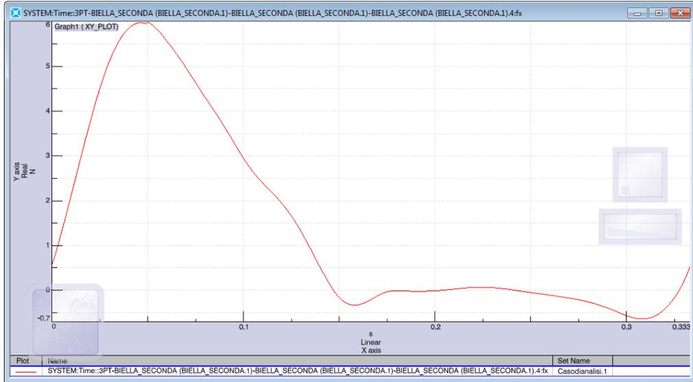
Figura 31: Andamento della resistenza applicata alla semi-ala esterna.
