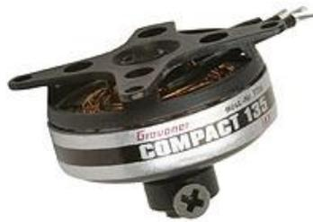
Figura 53: Motore Graupner Compact 135 7.4V. Peso 18.5 g; diametro 27.7 mm; lunghezza 13.5 mm; 12728 rpm (in assenza di carico); diametro dell'albero 3 mm.
