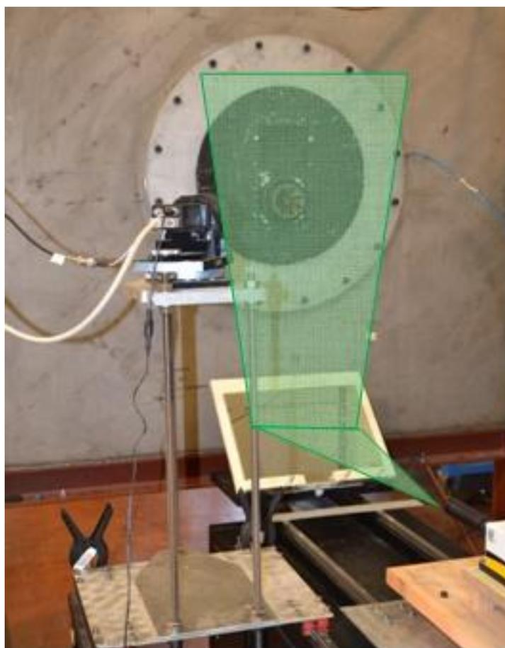
**Fig. 3.22** Schematizzazione della lama laser rispetto alle telecamere.
