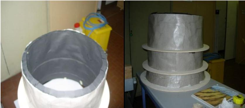
**Fig. 3.6** Fase di costruzione del simulacro del diffusore modello.
