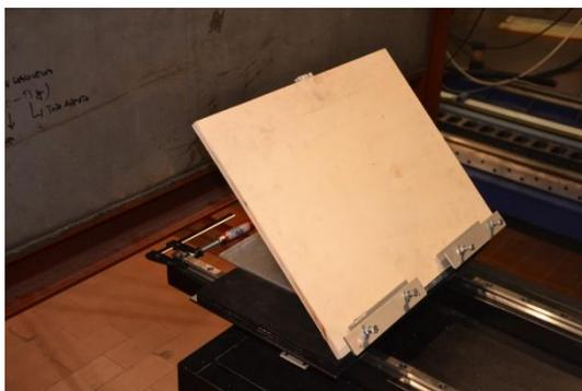
**Fig. 3.23** Sistema di sostegno per lo specchio.
