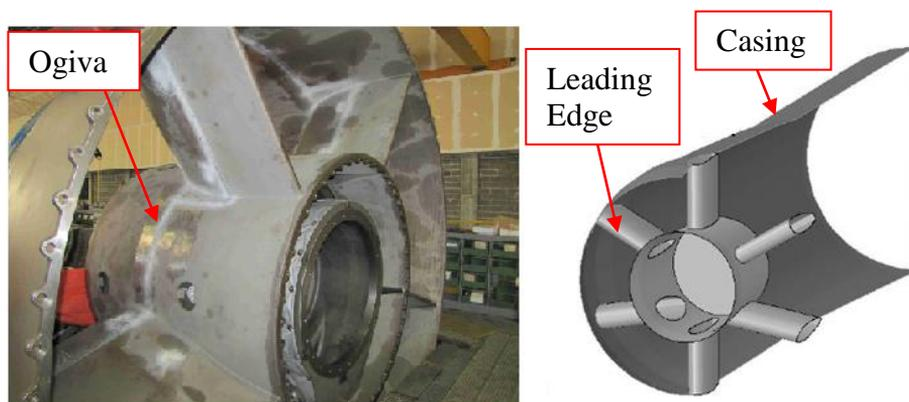
**Fig. 1.8** Particolare del canale meridiano del diffusore.
