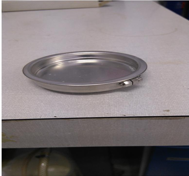
Mentre come rotore nelle prove di riferimento è stato usato il rotore originale PP50 (Parallel Plate 50mm) dell'Anton Paar di acciaio inossidabile e anche esso lavorato superficialmente col tornio (Anton Paar site 2015).
