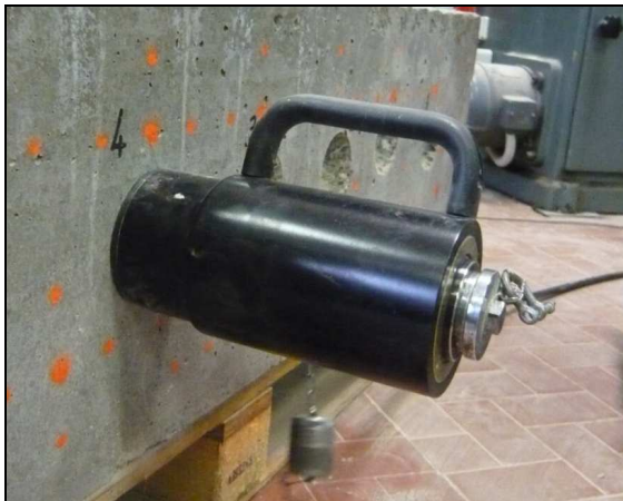
Figura 7: prova su calcestruzzo a stato tensionale nullo.
