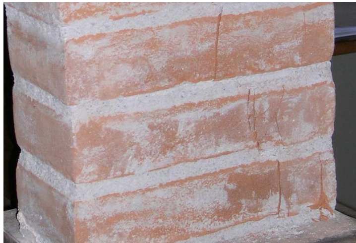
Figura 6 – Collasso della muratura di mattoni pieni: rottura del mattone per trazione trasversale.
