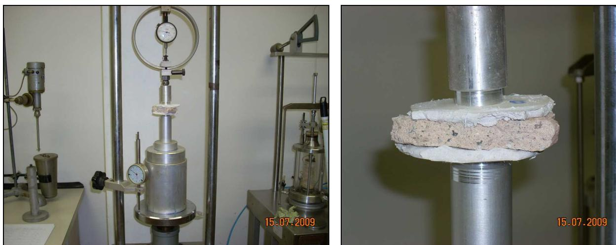
**Figura 49:** punching test sui giunti di malta. A DX il setup di prova, a SN il dettaglio della prova
