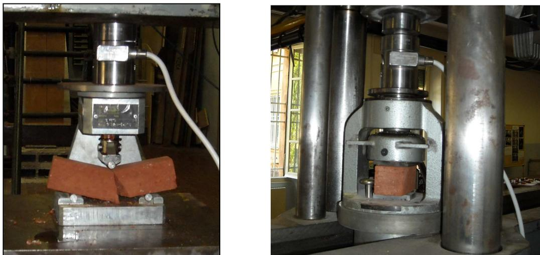
**Figura 48:** prove sui laterizi della muratura. A SN: prova di flessione su tre punti, a DX prova di compressione diretta.
