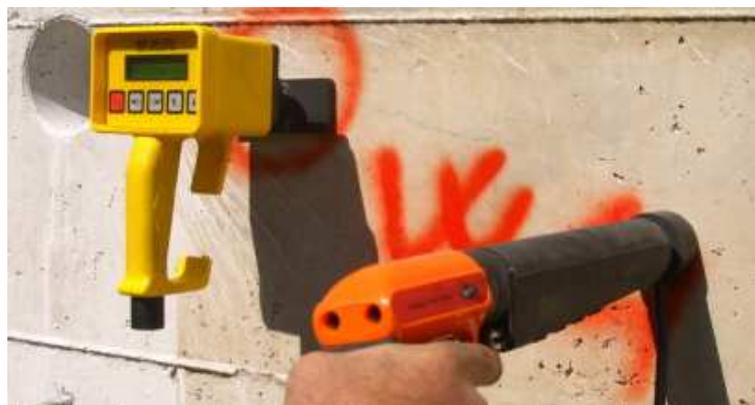
**Figura 19.** Sonda Windsor: a destra: infissione della sonda; a sinistra: misurazione della profondità di penetrazione
