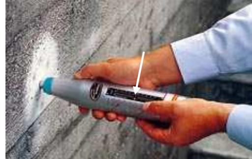
Figura 2. Sclerometro post-impatto (superficie levigata) con indicatore a metà scala.
