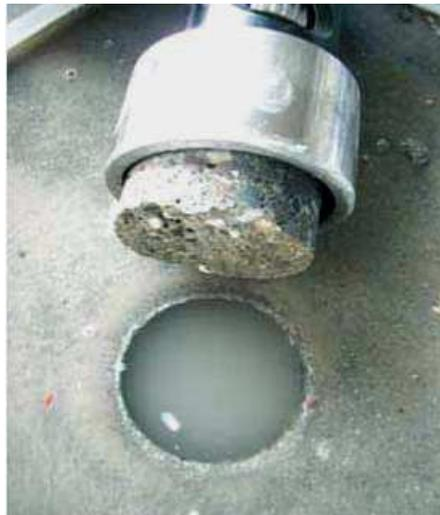
**Figura 22.** Prova di Pull-Off con rottura corretta.
