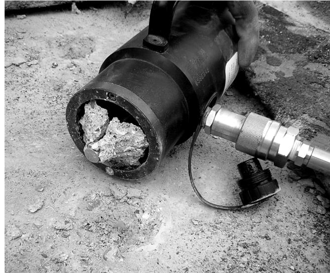
Figura 10. Martino idraulico di estrazione e coni di calcestruzzo estratti
