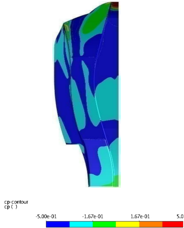
Figure 43: Coefficiente di pressione sul sottoscocca nel caso completo senza GV
