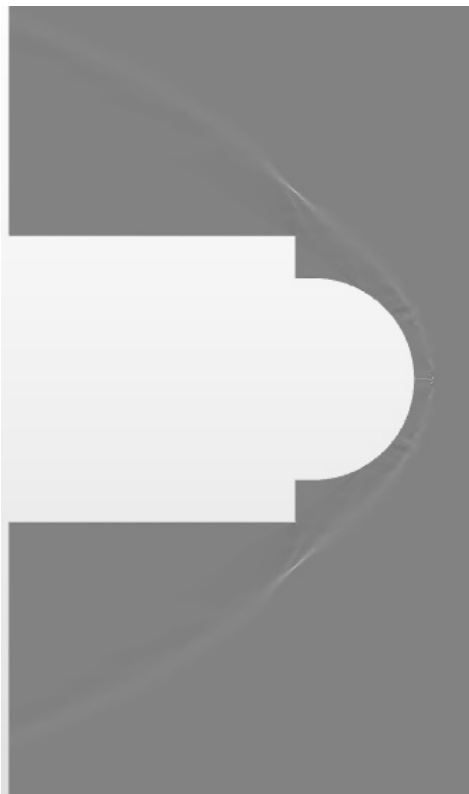
Figura 7.7: Gradiente della densità senza aerospike realizzato in Fluent
