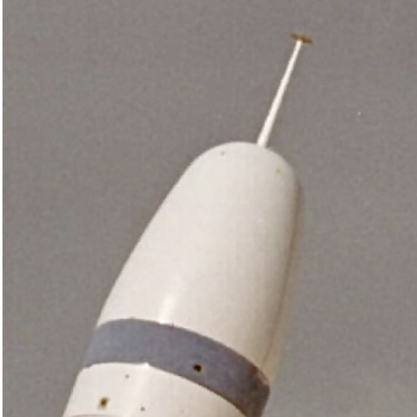
Figura 1.1: Aerospike applicato ad un missile balistico [3]
