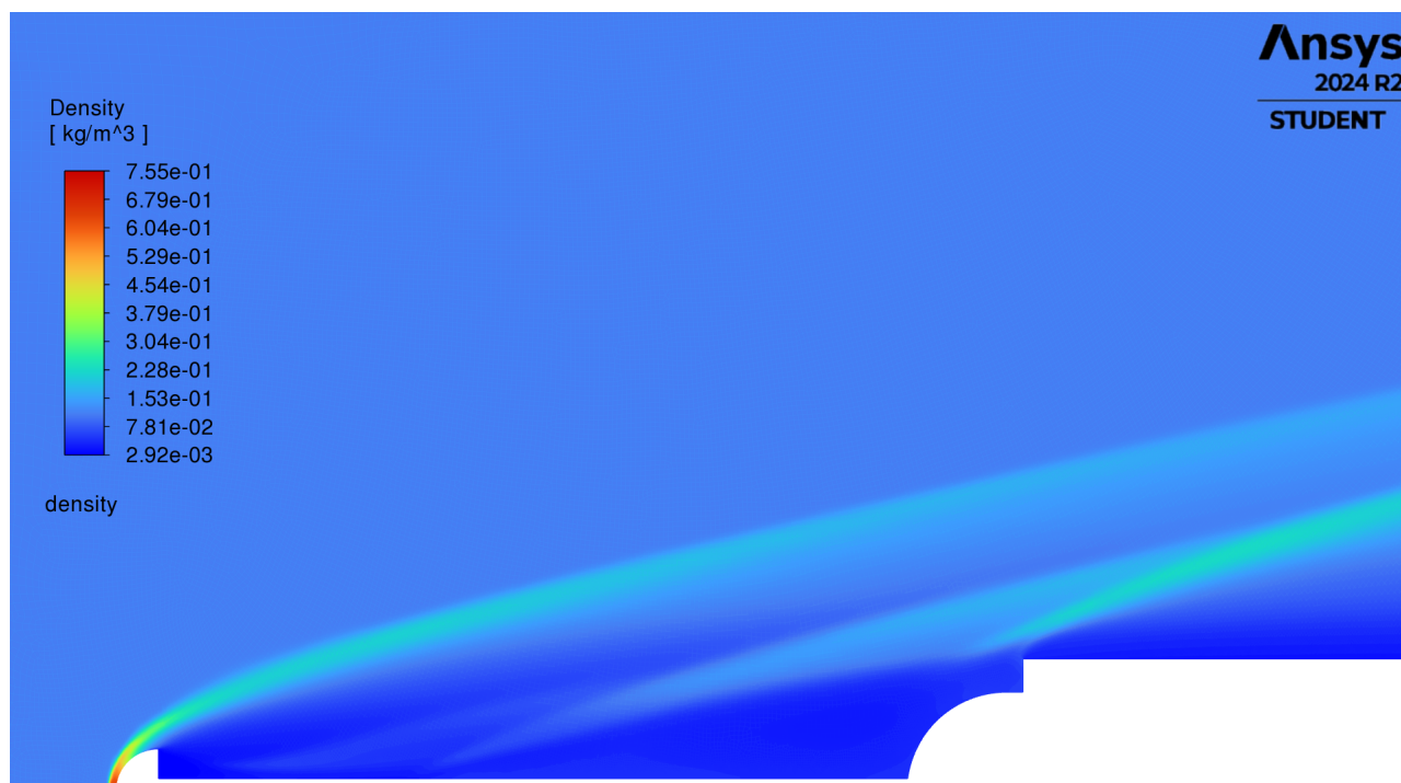
Figura 6.19: Distribuzione di densità attorno alla geometria con testa a semisfera, quella che è risultata avere le prestazioni superiori.
