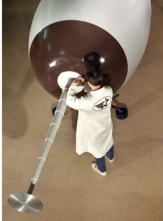
Figura 1.1: Aerospike mobile montato sulla sommità di un missile Trident, con un sistema per essere aperto dopo il lancio [4]
