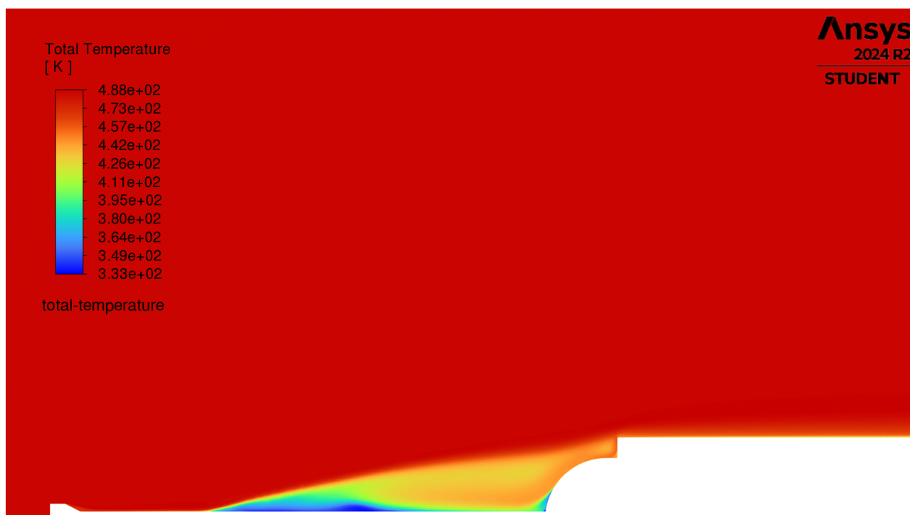
Figura 6.5: Distribuzione di temperatura totale dell'aerospike con D = 9.92\text{mm} , che ha la temperatura media minore in prossimità della cupola
