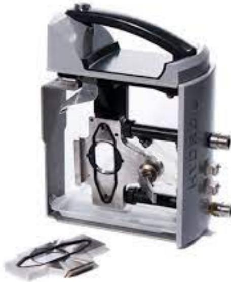
Figura 4.6: *Sistema di presentazione del campione.*
