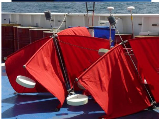
Figura 4.8: Diversi modelli di drifter CODE. Le dimensioni possono essere leggermente differenti, ma la struttura è analoga. Il tubo centrale contiene al suo interno la strumentazione elettronica; le quattro vele sono fra loro ortogonali e sono collegate al corpo centrale. I galleggianti vengono fissati nella parte superiore e terminale delle vele.
