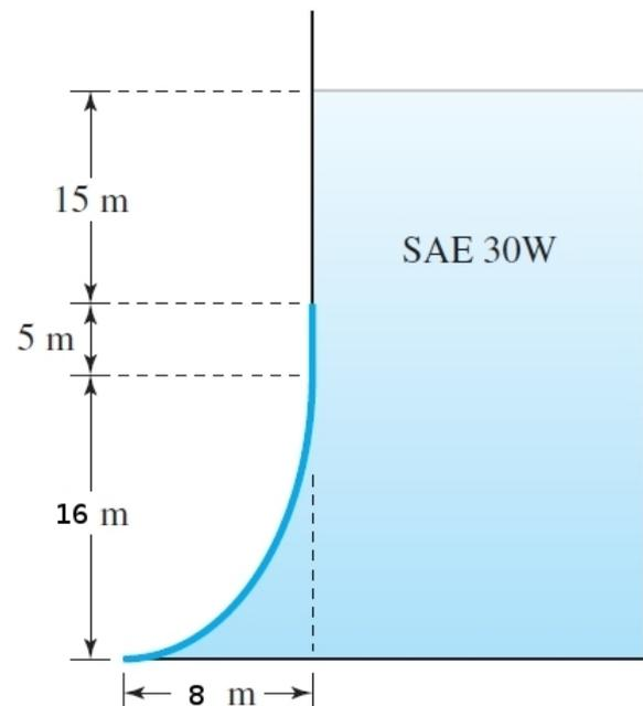
Si calcoli la forza esercitata dal fluido sulla paratoia rappresentata in figura, costituita nella parte inferiore da una parabola descritta dall'equazione  $y=ax^2$  e nella parte superiore da una superficie verticale. Si calcoli inoltre il momento da applicare nel vertice della parabola per mantenere la paratoia in equilibrio.
