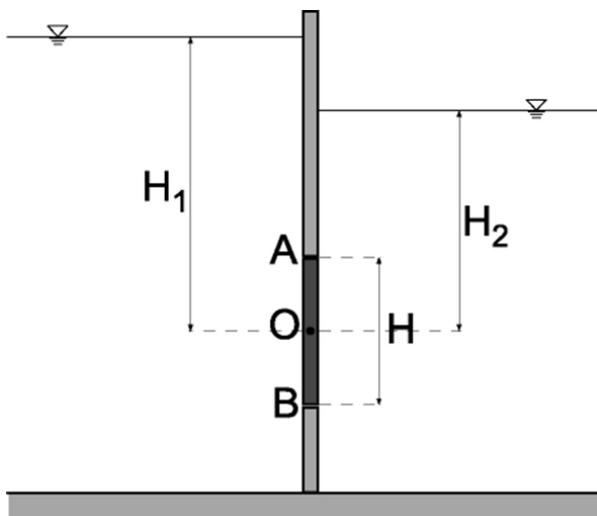
I due serbatoi adiacenti rappresentati in figura e contenenti acqua, sono collegati per mezzo di una paratoia piana rettangolare, di traccia AB, altezza  $H=4$  m e larghezza  $B=3$  m. Siano, inoltre,  $H_1=8$  m,  $H_2=6.5$  m. La paratoia piana è incernierata in O e ruota attorno ad un asse orizzontale passante per il suo baricentro. Si determini (in modulo, direzione e verso) la risultante **F** delle forze agenti sulla paratoia ed il momento **M** che si deve applicare in O per
