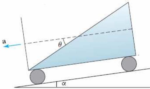
Un serbatoio di glicerina riempito parzialmente come in figura si muove lungo un piano inclinato di un angolo  $\alpha$  rispetto all'orizzontale e con una accelerazione  $a$  nella direzione del moto.
