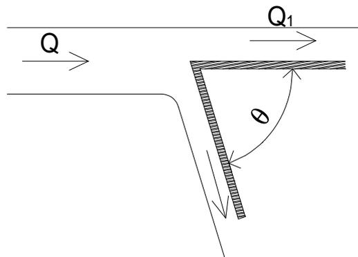
Determinare la forza esercitata dal getto caratterizzato da una sezione  $\Omega$  e da una portata volumetrica  $Q$  sulla superficie rappresentata in figura, trascurando gli effetti dissipativi e sapendo che la portata volumetrica che prosegue nella stessa direzione del getto incidente è pari a  $Q_1$  e la densità del fluido è  $\rho$ . La gravità agisce perpendicolarmente al piano rappresentato in figura.
