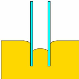
Un capillare di vetro di diametro  $d$  viene immerso nel mercurio. Si calcoli la relazione analitica per l'abbassamento del fluido all'interno del capillare, essendo  $\phi$  l'angolo di contatto tra fluido e vetro (si definisca
